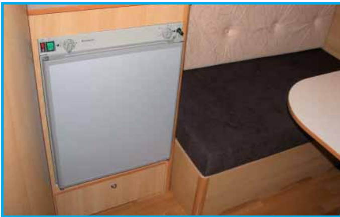
Jääkaappi on hyvää mallia ja toimii tarpeen mukaan kaasulla, akulla tai sähköllä.
